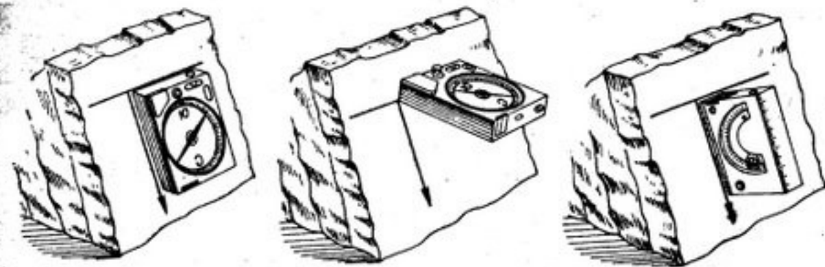
Рис. 2.1. Последовательность операций при ориентировке штуфа с помощью горного компаса с уровнем.
