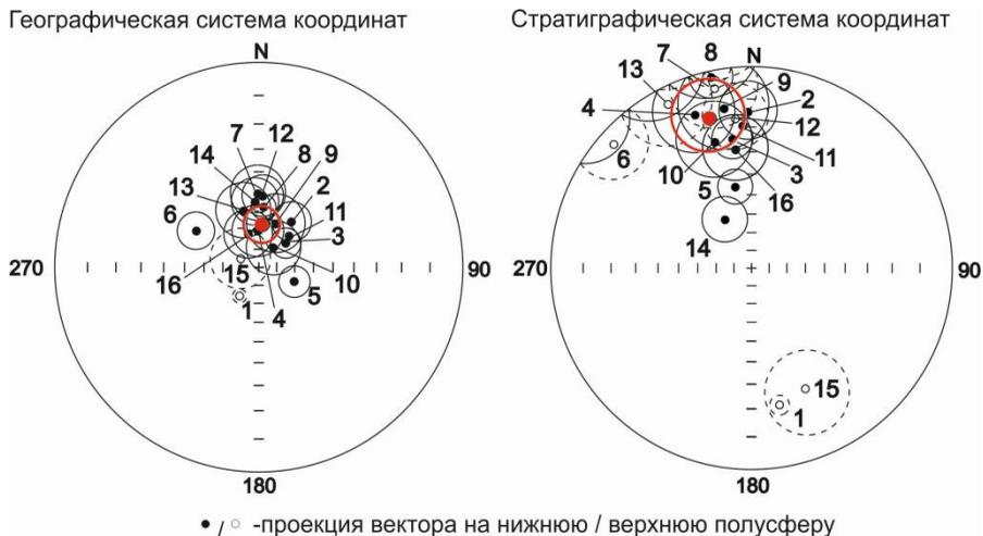
**Рис. 1.** Средние палеомагнитные направления для исследованных тел в географической и стратиграфической системах координат (по сайтам). Номера объектов совпадают с таблицей.
